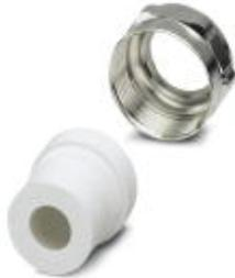
Halbverschraubung Pg21, aus Metall, bestehend aus Dichtgummi mit einer Bohrung und einer Druckschraube, für Gehäuse der Bauform 2 - 4, Kabel [mm] 11,5 - 13,5
