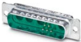
D-SUB-Kontakteinsatz, Shell-Größe 3, mit 5 Signalkontakten, mit Lötkelch, gerade, Aufnahme für 4 Kombinationskontakte, Kontaktart Stift, Befestigung mittels Bohrung 3 mm, für Anbaurahmen und Tüllengehäuse VS-25-...
