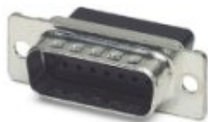
D-SUB-Kontaktträger, Shell-Größe 2, für 15 Signalkontakte, Kontaktart Stift, für Crimpkontakte, gerade, Befestigung mittels Bohrung 3 mm, für Anbaurahmen und Tüllengehäuse VS-15-...
