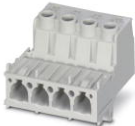
Kontakteinsatz-Modul, für Anbaurahmen, mit Schraubanschluss, 3-polig + PE, 690 V / 70 A
