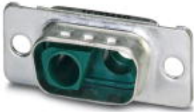
D-SUB-Kontaktträger, Shell-Größe 1, Aufnahme für 2 Kombinationskontakte, Kontaktart Stift, gerade, Befestigung mittels Bohrung 3 mm, für Anbaurahmen und Tüllengehäuse VS-09-...
