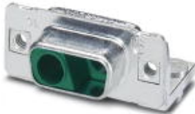
D-SUB-Kontaktträger, Shell-Größe 1, Aufnahme für 2 Kombinationskontakte, Kontaktart Buchse, Befestigung mittels Gewinde 4-40 UNC und Lötzapfen, für Anbaurahmen VS-09-...
