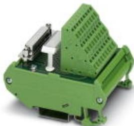
VARIOFACE-Modul, mit Zugfederklemmenanschluss und D-Subminiatur-Buchsenleiste, zur Montage auf NS 35/7,5 oder NS 32, Polzahl 25
