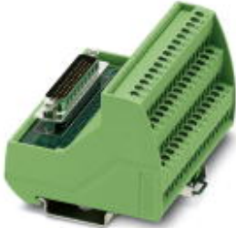
VARIOFACE-Modul, mit Schraubanschluss und High-Density-D-SUB-Miniatur-Buchsenleiste, zur Montage auf NS 35-Tragschienen, Polzahl: 26, Breite: 79 mm
