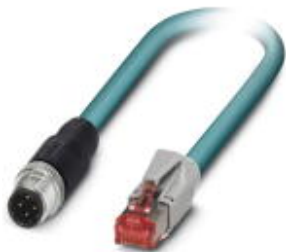
Konfektioniertes Ethernet-Kabel, CAT5e, geschirmt, 2-paarig, AWG 26 flexibel (7-drähtig), RAL 5021 (wasserblau), M12-Stecker auf RJ45-Stecker/IP20, Line, Länge 3 m
