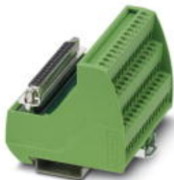
VARIOFACE-Modul, mit Schraubanschluss und D-SUB-Miniatur-Buchsenleiste, zur Montage auf NS 35-Tragschienen, Polzahl: 37
