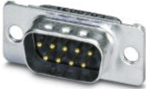
D-SUB-Kontakteinsatz, Shell-Größe 1, mit 9 Signalkontakten, Kontaktart Stift, mit Lötkelch, gerade, Befestigung mittels Bohrung 3 mm, für Anbaurahmen und Tüllengehäuse VS-09-...
