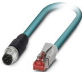
Konfektioniertes Ethernet-Kabel, CAT5e, geschirmt, 2-paarig, AWG 26 flexibel (7-drähtig), RAL 5021 (wasserblau), M12-Stecker auf RJ45-Stecker/IP20, Line, Länge 1 m
