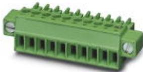
Steckerteil, Nennstrom: 8 A, Bemessungsspannung (III/2): 160 V, Polzahl: 6, Rastermaß: 3,81 mm, Anschlussart: Schraubanschluss, Farbe: grün, Kontaktoberfläche: Zinn
