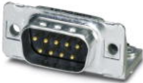
D-SUB-Kontakteinsatz, Shell-Größe 1, mit 9 Signalkontakten, Kontaktart Stift, für Leiterplattenmontage, abgewinkelt, Befestigung mittels M3 Gewinde und Lötzapfen, für Anbraurahmen VS-09-...
