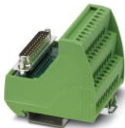
VARIOFACE-Modul, mit Schraubanschluss und D-SUB-Miniatur-Stiftleiste, zur Montage auf NS 35-Tragschienen, Polzahl: 25
