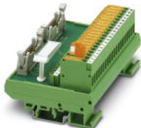
VARIOFACE-Übergabemodul für Siemens SIMATIC® S7-300, für max..16 Kanäle mit SIMATIC®-spezifischer Beschriftung (1 - 20), Messertrennklemme und Prüfabgriff, Modulbreite: 113 mm
