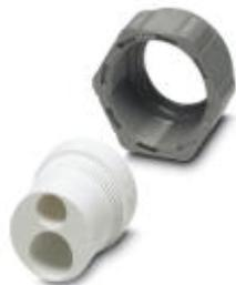
Halbverschraubung Pg21, aus Kunststoff, bestehend aus Dichtgummi mit mehreren Bohrungen (1 x 8,5 mm / 1 x 12 mm) und einer Druckschraube, für Kabelverschraubungsstutzen VC-M-KV-PG21.....
