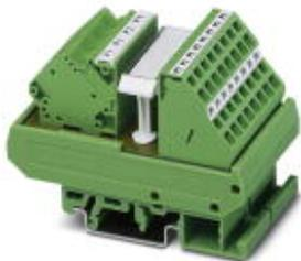
VARIOFACE-Modul, mit zwei Potenzialschienen (P1, P2) zur Potenzialverteilung, zur Montage auf NS 35/7,5 oder NS 32. Modulbreite: 90 mm
