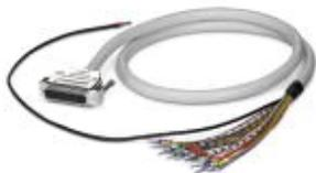
Geschirmtes Kabel mit einer 25-poligen D-SUB-Buchsenleiste und einem offenem Ende. Die Einzeladern sind von 1 bis 25 beschriftet und mit Aderendhülsen versehen. Das Schirmgeflecht ist auf ein separates Kabelende heraus geführt. Kabellänge: 2 m
