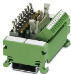
VARIOFACE-Schalter-Modul, mit Flachbandkabel- und COMBICON-Steckverbinder, zur Simulation, für 8 Signale, zur Montage auf NS 35/7,5
