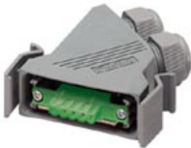
D-SUB-Komplett-Steckverbinder, für DeviceNet, Shell-Größe 3, Steckerteil, Schraubanschluss, ungeschirmt, Anschlussrichtung gerade, Schutzart IP67
