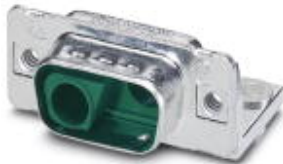
D-SUB-Kontaktträger, Shell-Größe 1, Aufnahme für 2 Kombinationskontakte, Kontaktart Stift, Befestigung mittels Gewinde 4-40 UNC und Lötzapfen, für Anbaurahmen VS-09-...
