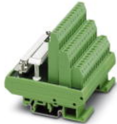
VARIOFACE-Modul, mit Schraubanschluss und D-Subminiatur-Buchsenleiste, zur Montage auf NS 35/7,5 oder NS 32, Polzahl 37
