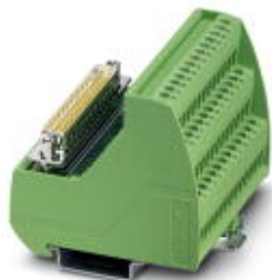
VARIOFACE-Modul, mit Schraubanschluss und D-SUB-Miniatur-Buchsenleiste, zur Montage auf NS 35-Tragschienen, Polzahl: 25
