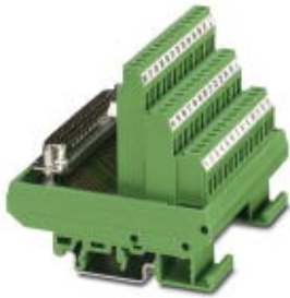
VARIOFACE-Modul, mit Schraubanschluss und D-Subminiatur-Stiftleiste, zur Montage auf NS 35/7,5 oder NS 32, Polzahl 50
