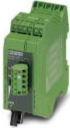
LWL-Konverter mit integrierter optischer Diagnose, für DeviceNet™, CAN, CANopen® bis 1000 kbit/s, Endgerät, Schnittstellen: 1 x CAN, 1 x Alarm, 1 x LWL (B-FOC), 850 nm, für HCS-/Glasfaser (Multimode)
