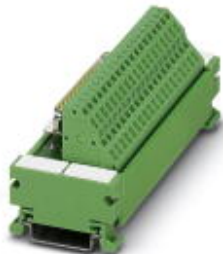
VARIOFACE-Modul, mit Zugfederanschluss und D-Subminiatur-Stiftleiste, zur Montage auf NS 35/7,5, Polzahl 9
