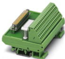
Standard 1:1 D-SUB Modul, mit Zugfederanschluss und D-SUB-Stiftleiste, Polzahl 25
