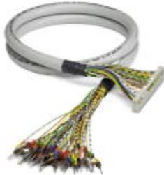
Rundkabel konfektioniert mit einer 14-poligen Federleiste und einem offenen Ende. Am offenen Ende sind die Adern von 1 bis 14 beschriftet und mit Aderendhülsen versehen, Kabellänge: 2,5 m
