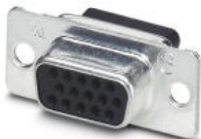
D-SUB-Kontaktträger, Shell-Größe 1, für 15 Signalkontakte, Kontaktart Buchse, für Crimpkontakte, gerade, Befestigung mittels Bohrung 3 mm, für Anbaurahmen und Tüllengehäuse VS-09-...
