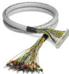
Rundkabel konfektioniert mit einer 20-poligen Federleiste und einem offenen Ende. Am offenen Ende sind die Adern von 1 bis 20 beschriftet und mit Aderendhülsen versehen, Kabellänge: 2 m
