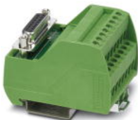
VARIOFACE-Modul, mit Schraubanschluss und D-SUB-Miniatur-Buchsenleiste, zur Montage auf NS 35-Tragschienen, Polzahl: 15
