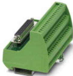
VARIOFACE-Modul, mit Schraubanschluss und D-SUB-Miniatur-Buchsenleiste, zur Montage auf NS 35-Tragschienen, Polzahl: 50
