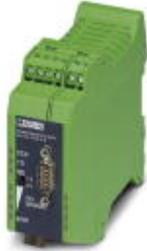
LWL-Konverter mit integrierter optischer Diagnose, Alarmkontakt, für RS-232-Schnittstellen bis 115,2 kBit/s, Endgerät mit einer LWL-Schnittstelle (FSMA), 660 nm, für Polymer-/HCS-Faserkabel
