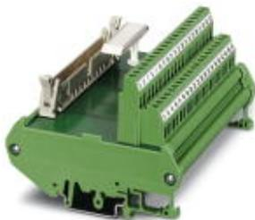
VARIOFACE-Übergabemodul für Siemens SIMATIC® S7-300, mit SIMATIC®-spezifischer Beschriftung (1 - 40), Schraubanschluss, Modulbreite: 113 mm
