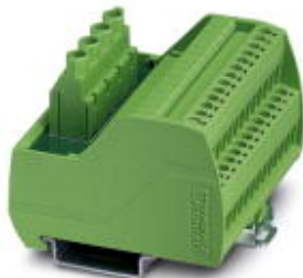
VARIOFACE-Modul, mit zwei Potenzialschienen (P1, P2) zur Potenzialverteilung, zur Montage auf NS 35-Tragschienen. Modulbreite: 50,0 mm
