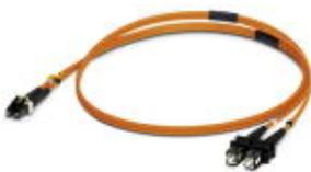
Konfektioniertes LWL-Kabel, Break-Out-Kabel, Glasfaser Multimode 50/125  $\mu\text{m}$ , Stecker: LC / SC-Duplex, Schutzart: IP20, für die Verlegung in Kabelkanälen oder Schaltschränken, Länge: 1 m
