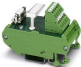
VARIOFACE-Modul, mit Zugfederklemmenanschluss und D-Subminiatur-Buchsenleiste, zur Montage auf NS 35/7,5 oder NS 32, Polzahl 9
