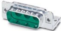
D-SUB-Kontaktträger, Shell-Größe 2, Aufnahme für 3 Kombinationskontakte, Kontaktart Stift, Befestigung mittels Gewinde 4-40 UNC und Lötzapfen, für Anbaurahmen VS-15-...
