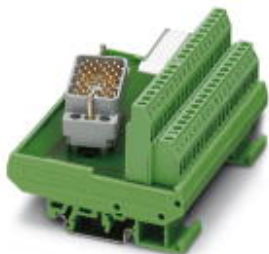
VARIOFACE-Modul, für ELCO-Steckverbinder, zur Montage auf NS 35/7,5 oder NS 32, mit Stiftleiste 8016 rechts, Polzahl 38
