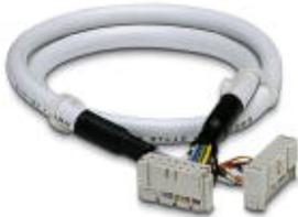
Konfektioniertes Rundkabel, für Frontadapter der Siemens SIMATIC® - Serie "TOP connect", mit einer 16-poligen und einer 14-poligen Federleiste, zur Übergabe von 8 Kanälen, Kabellänge: 4 m
