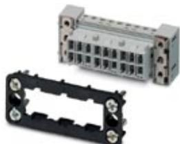
Kontakteinsatzset für Anbauseite, Tüllenrahmen mit PE, 4 Befestigungsschrauben, 6-polige Kontakteinsätze vormontiert, 6 Kodierprofile, 2 Anbauflansche
