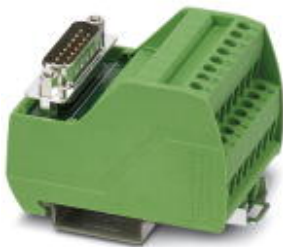
VARIOFACE-Modul, mit Schraubanschluss und D-SUB-Miniatur-Stiftleiste, zur Montage auf NS 35-Tragschienen, Polzahl: 15
