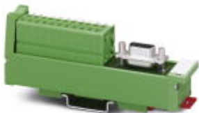
VARIOFACE SLIM-LINE, mit Schraubanschluss und D-Subminiatur-Buchsenleiste, zur Montage quer auf NS 35/7,5, Polzahl 15
