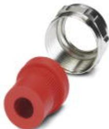
Halbverschraubung Pg16, aus Metall, bestehend aus Dichtgummi mit einer Bohrung und einer Druckschraube, für Gehäuse der Bauform 1, Kabel [mm] 9 - 13
