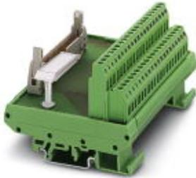
VARIOFACE-Modul, mit Schraubanschluss und Flachbandkabel-Steckverbinder, zur Montage auf NS 32 oder NS 35/7,5, mit Stiftleiste sowie kurzen und langen Verriegelungsklinken für Federleisten, Polzahl 16
