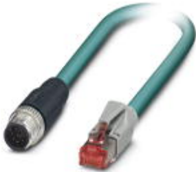
Konfektioniertes Ethernet-Kabel, geschirmt, 4-paarig, AWG 26 flexibel (7-drähtig), RAL 5021 (wasserblau), M12-Stecker auf RJ45-Stecker/IP20, Line, Länge 3 m
