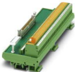
VARIOFACE-Übergabemodul für Siemens SIMATIC® S7-300, mit SIMATIC®-spezifischer Beschriftung (1 - 40), Messertrennklemme und Prüfabgriff, Modulbreite: 214 mm
