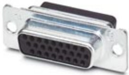
D-SUB-Kontaktträger, Shell-Größe 2, für 26 Signalkontakte, Kontaktart Buchse, für Crimpkontakte, gerade, Befestigung mittels Bohrung 3 mm, für Anbaurahmen und Tüllengehäuse VS-15-...
