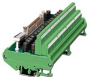
VARIOFACE-Modul, für 32 Kanäle mit je einer zusätzlichen Klemme und Sicherung pro Signal, (gemeinsames Minuspotenzial)
